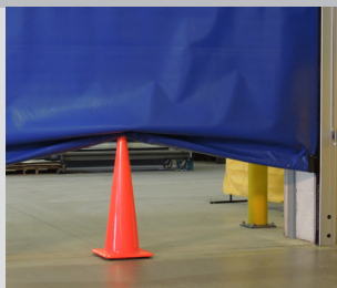
El borde flexible se flexa alrededor de los objetos
