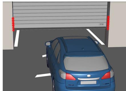
Rouge en cascade dans le sens du mouvement lorsque la porte s'ouvre ou se ferme.
