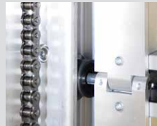
Rouleaux avec roulements à rouleaux scellés
