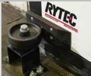
Se muestra el rodillo de permanencia y el panel
